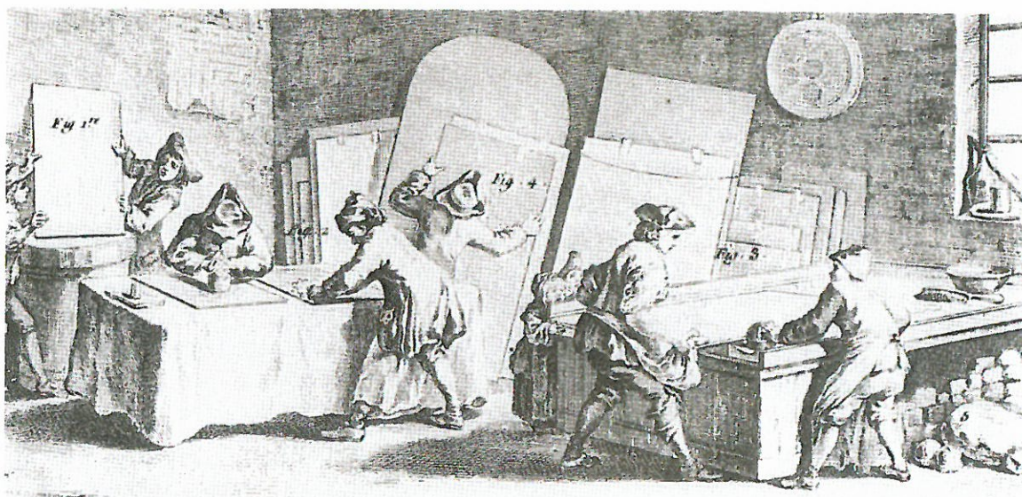
Fig. 8. Foliering af spejlglass med tin og kviksølv. De to mænd yderst til venstre er ved at slibe kanterne på en glasplade, før den skal belægges. Til højre er belæggeren ved at skyde en færdigslebet glasplade ind over det flydende kviksølv.
